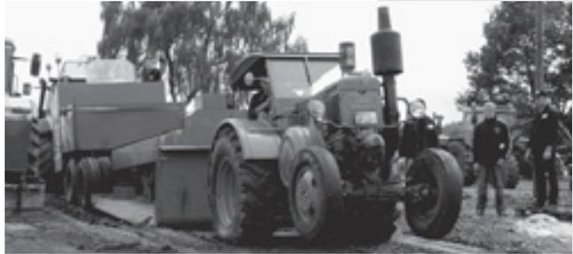
Ziel unseres Trecker-Trecks ist es, mit dem Schlepper einen Bremswagen über eine 100 Meter-Distanz auf üblichem Erdboden zu ziehen. Da der Bremswagen mit jeder Radumdrehung die Zugkraft auf den Trecker erhöht, wird es für jeden Teilnehmer eine Herausforderung sein, die „Full Pull“ (100 m) zu meistern.
